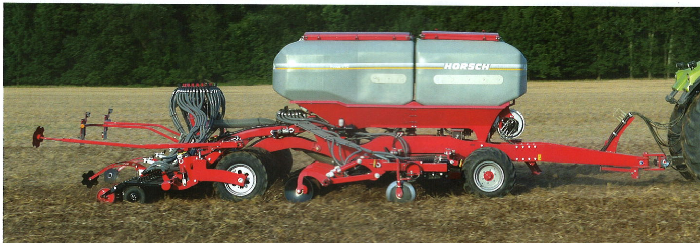
Cílené hnojení při setí – HORSCH Focus 6 TD, model 2014.
